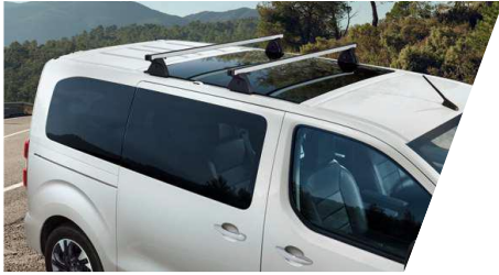
Priečny strešný hliníkový nosič – 1 ks. strešné tyče z anodizovaného hliníka. Upevnenie do kotviacich bodov v streche. Max. záťaž: 100 kg/2nosiče, 150kg/3nosiče. Číslo dielu: 1612491580 Cenníková cena: 233,86 €
