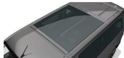
Presklená strecha so snečnou clonou (oK01)
